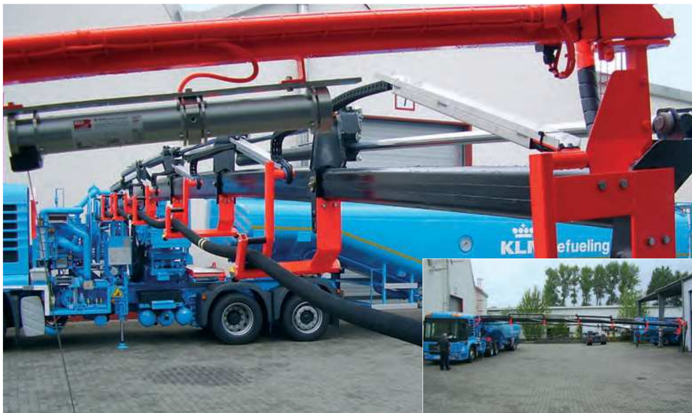
E2/000 série 1400 tankovací cisterna pro letadla; teleskopický jeřáb se šesti sekcemi
